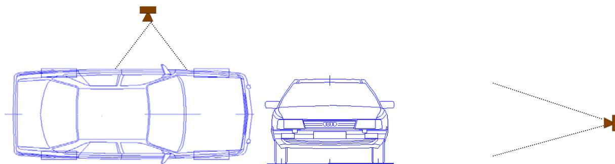
Рис. 2. Схема выполнения фотосъемки поврежденной левой передней двери.
